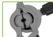
Odkręć i wymień trzpień wewnętrzny na inny rozmiar
